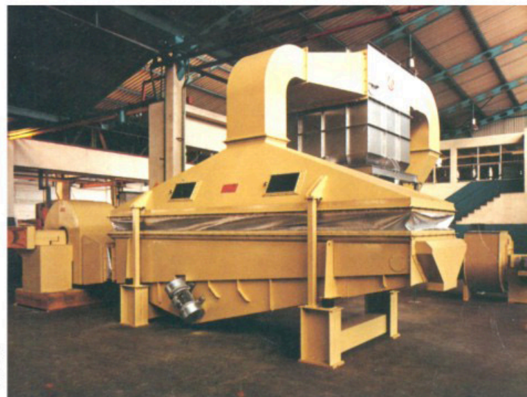
Resfriador contínuo por leito fluidizado com filtro de mangas. Continuous fluid-bed cooler with dust collecting filter.
