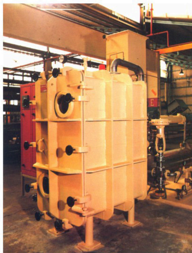
Secador estacionário a vácuo com prateleiras aquecidas. Vacuum chamber with heated shelves.
