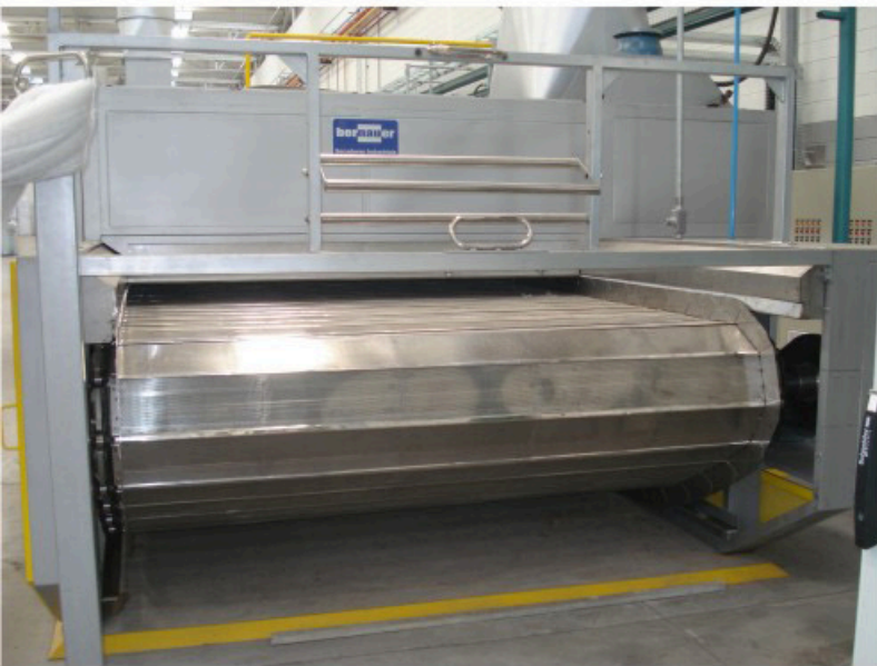
Secador contínuo de esteira para fibra de poliéster. Continuous conveyor dryer for polyester fiber.
