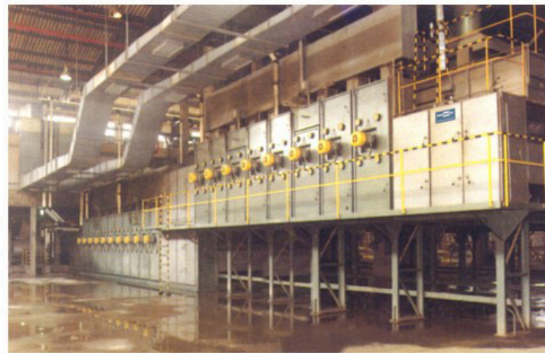
Secador contínuo com dois estágios para borracha sintética e resinas. Two decks continuous air dryer for synthetic rubber and resins.
