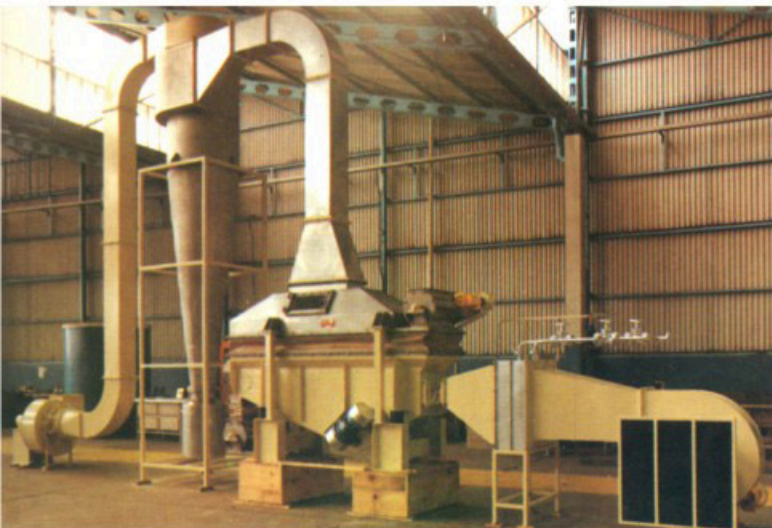
Secador contínuo por leito-fluidizado vibratório. Continuous dryer vibrating fluid-bed.
